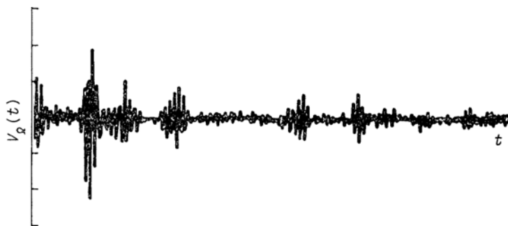
Εικ. 8. Διαλείπον σήμα μετρημένης ταχύτητας με φίλτρο διάβασης υψίσυχνων αρμονικών V_{\Omega}(t) . (Πηγή: Frisch, 1985)
