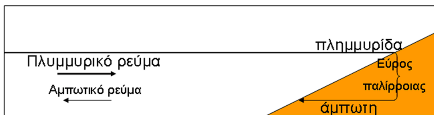
Σχήμα 4.18 «Πλημμυρικό» ( flood current ) και «αμπωτικό» ( ebb current ) ρεύμα.
