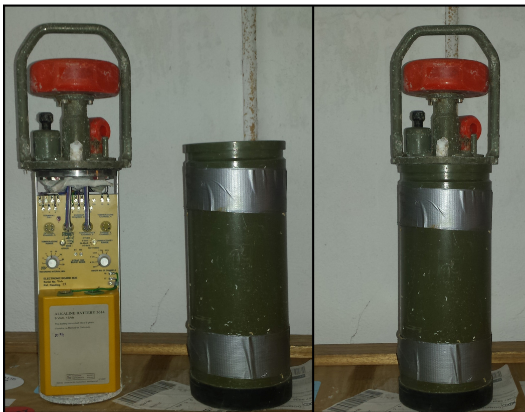
Εικόνα 4.3 Στατικός βυθισμένος ρευματογράφος. [πηγή: Εργαστήριο Θαλάσσιας Τεχνικής και Θαλασσιών Έργων, ΑΠΘ]
