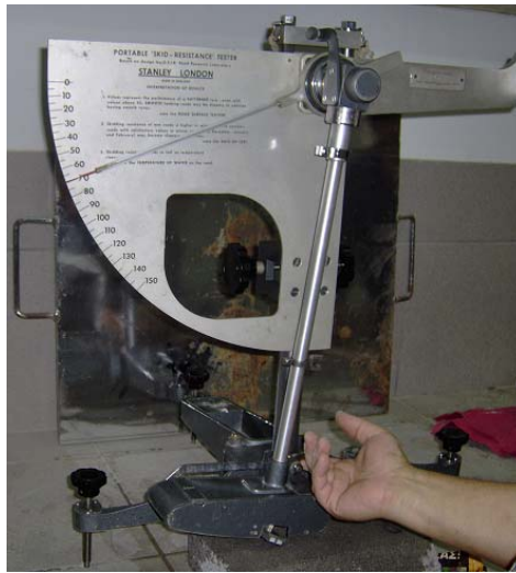
Φωτογραφία 1. Μέτρηση της αντίστασης σε ολίσθηση κρασπέδων από σκυρόδεμα
