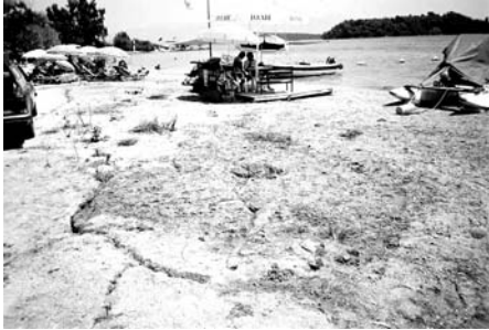
Σχήμα 8α. Νυδρί-Παλιά εκβολή Δημοσάρι: Ανάδυση υλικού από εδαφικές διαρρήξεις
