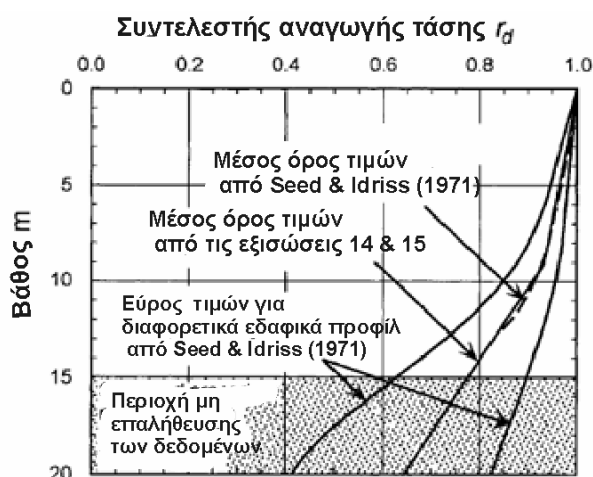
Σχήμα 3.4 Μεταβολή του r_d σε σχέση με το βάθος (από Youd και Idriss, 2001)
