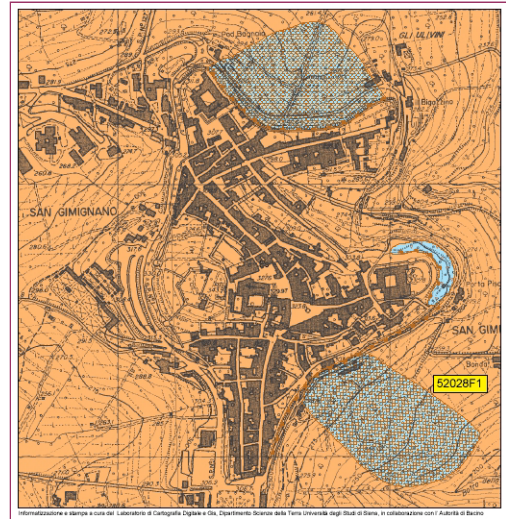
Map representing the main landslides in the area (by Autorità di bacino del Fiume Arno)
