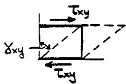
$$\text{Μετρο ειρηγης } G : \gamma_{xy} = \frac{\tau_{xy}}{G} , \quad G \text{ (N/m}^2\text{)}.$$
