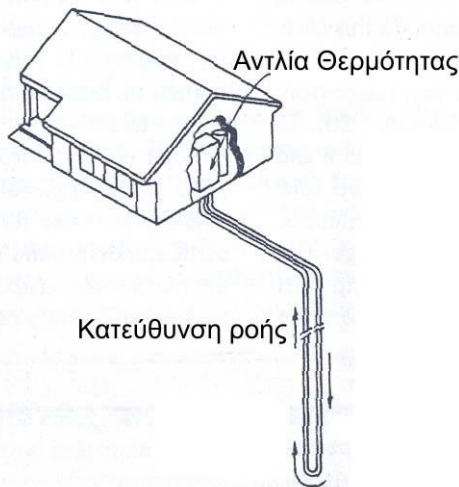
Εικόνα 4: Κατακόρυφος γεωεναλλάκτης. Figure 4: Vertical ground heat exchanger.
