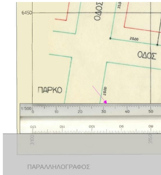
Εικόνα 1.19: Εκτίμηση της τετμημένης του σημείου χρησιμοποιώντας το κλιμακόμετρο
