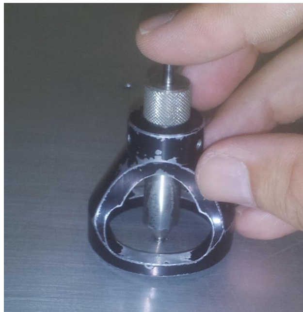
Εικόνα 1.3: Εξάρτημα για τη σήμανση στο χαρτί της θέσης του κόμβου του κανάβου
