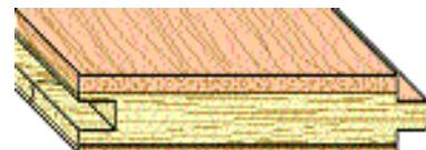
Σχήμα 5. Πολύστρωμα ξύλινα δάπεδα (engineered wood floors)
