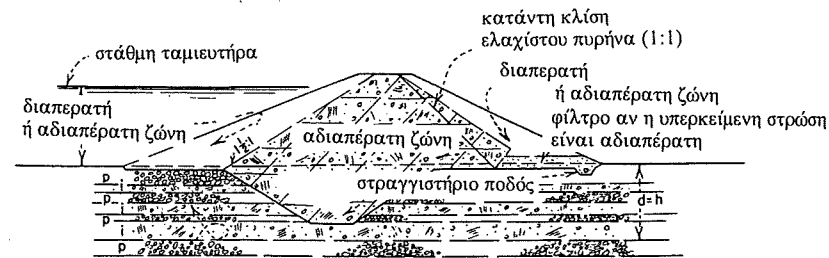
εντόνος στρωματοποιημένη διαπερατή θεμελίωση με πολύ διαπερατά (p) και σχετικώς αδιαπέρατα στρώματα (i)
