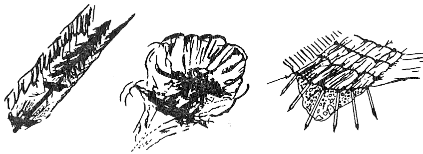
Επίστρωση του πυθμένα με φυτικό υλικό
